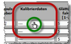
c) Das Fenster auf der rechten Seite wird geöffnet und eine Liste aller Seriennummern angezeigt, die in der(den) Kalibrierdaten-Datei(en) enthalten sind. Wählen Sie die Seriennummer des entsprechenden Gaszählers aus.
