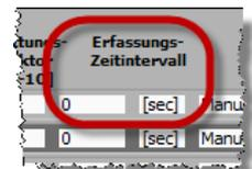
Die Einheit des Zeitintervalls kann auf [sec], [min] oder [h] festgesetzt werden; das kleinste Intervall beträgt 1 sec. Bei einem kurzen Intervall ist bei Langzeitmessungen der verfügbare Datenspeicher zu beachten.
